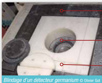
Blindage d'un détecteur germanium © Olivier Got
